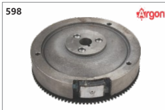
Código: 20007 Volante magnético c/ cremalheira 11,0 / 13,0 / 15,0 / 16,0hp (PE)
